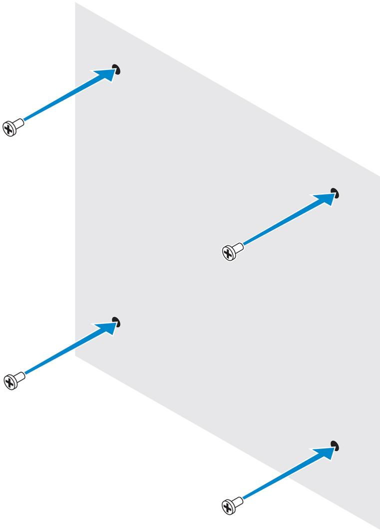
6. Alinee los orificios de los tornillos en el soporte de montaje estándar con los tornillos y coloque el sistema Edge Gateway en la pared.
