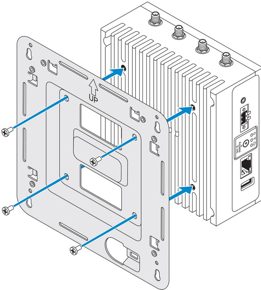
2. Coloque el sistema Edge Gateway contra la pared y alinee los orificios del soporte de montaje estándar con los orificios en la pared. Los orificios para tornillos del soporte tienen un diámetro de 3 mm (0,12 pulg.).
