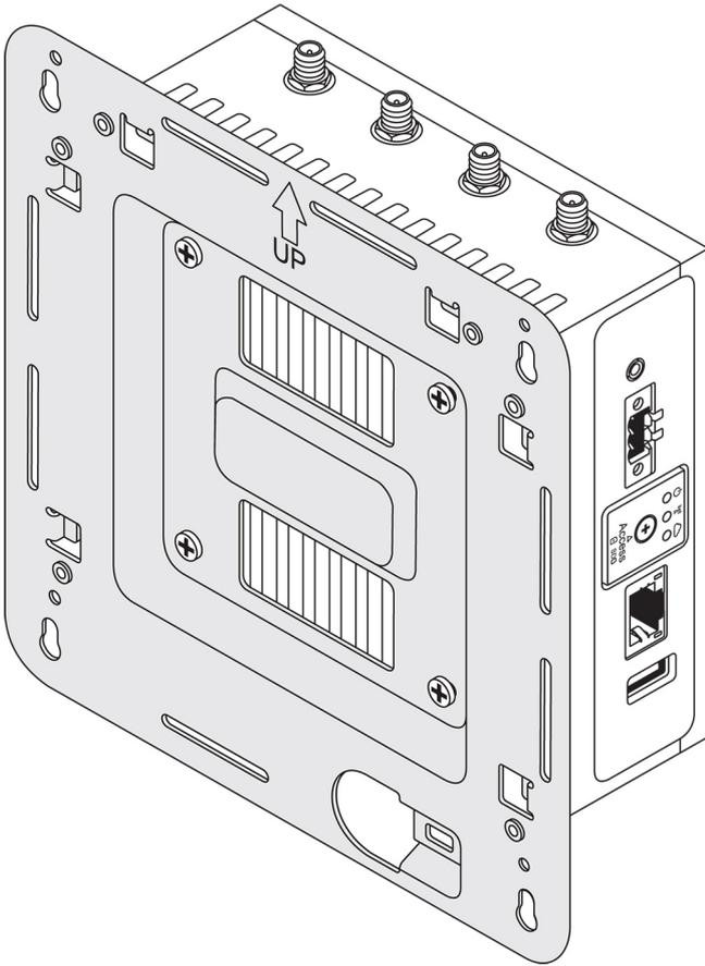
3. Coloque el soporte de montaje estándar en la pared y, mediante los orificios que se encuentran encima de los orificios para tornillos del soporte, marque las ubicaciones para taladrar los cuatro agujeros.
