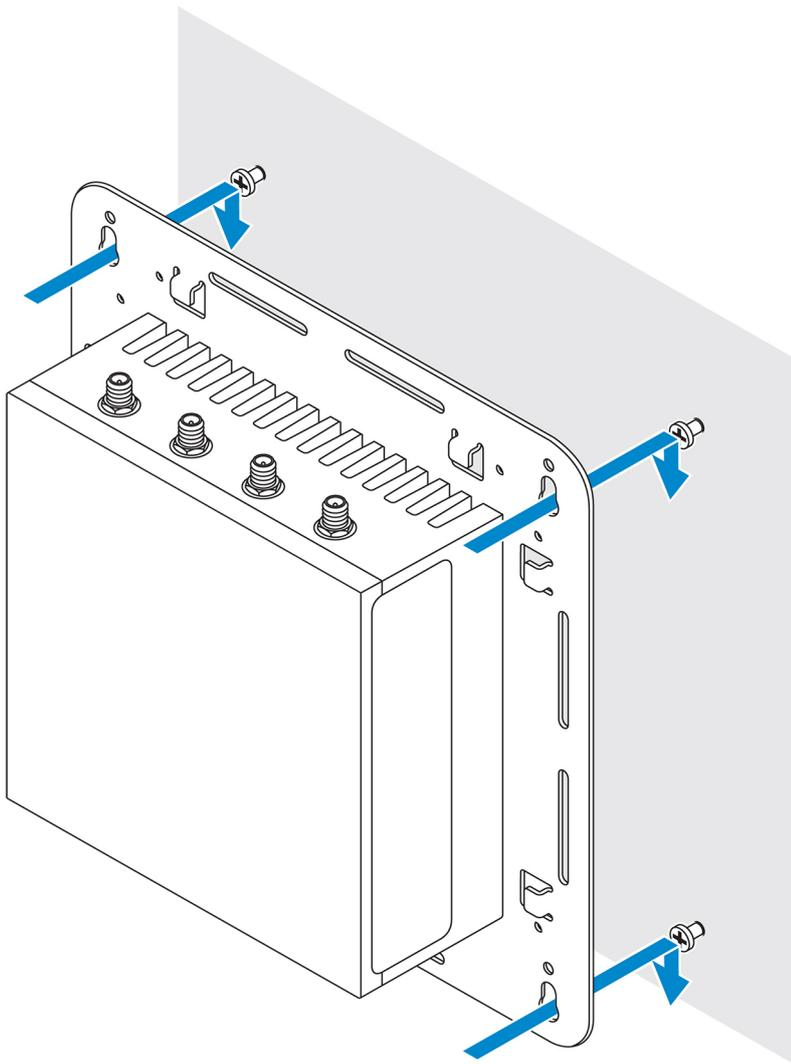
7. Ajuste los tornillos para fijar el ensamblaje a la pared.
