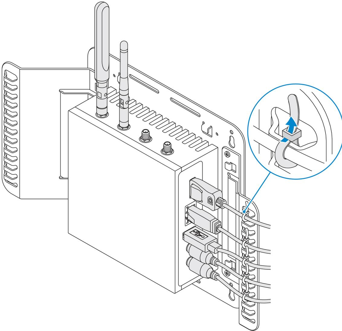
5. Conecte los cables al sistema Edge Gateway.
