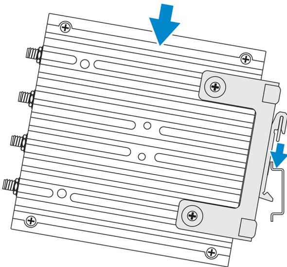
5. Empuje el sistema Edge Gateway hacia el riel DIN para fijar el gancho inferior del soporte al riel DIN.
