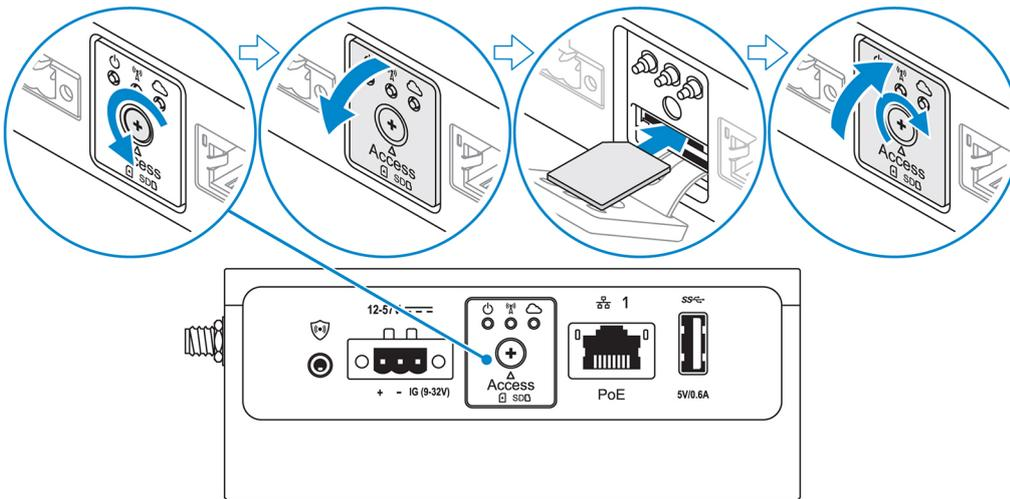
3. Coloque el tornillo y cierre la puerta de acceso a la tarjeta micro-SIM.
