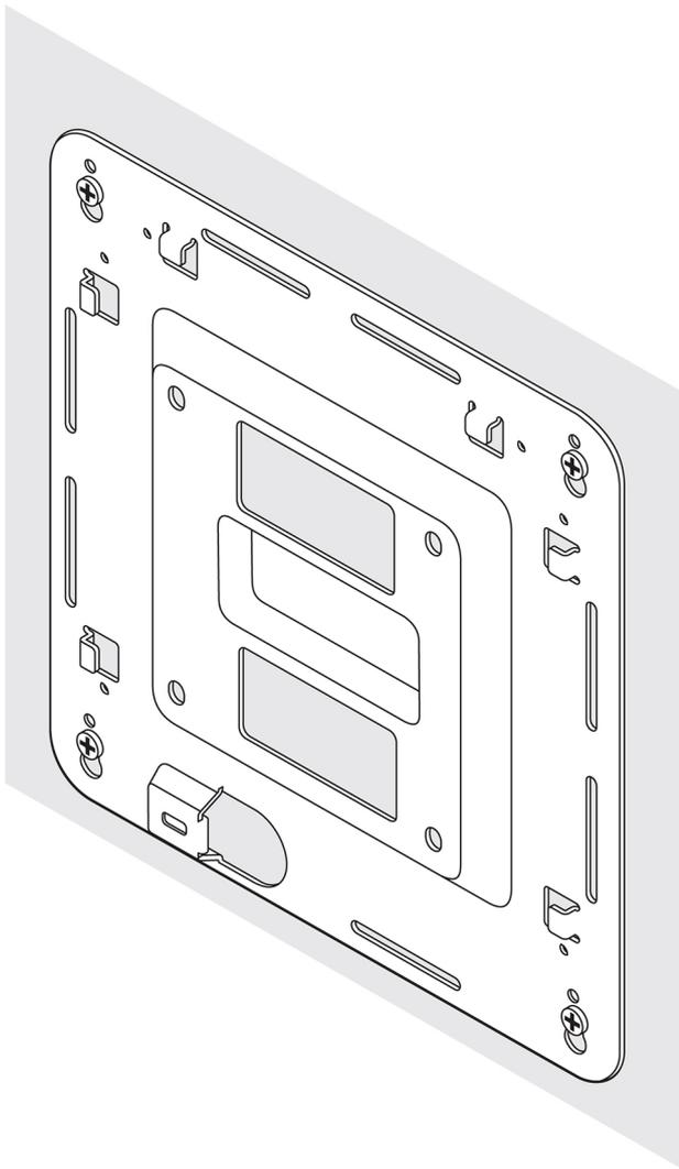
6. Alinee los orificios para tornillos del soporte de riel DIN con los orificios para tornillos de la parte posterior del sistema Edge Gateway.
