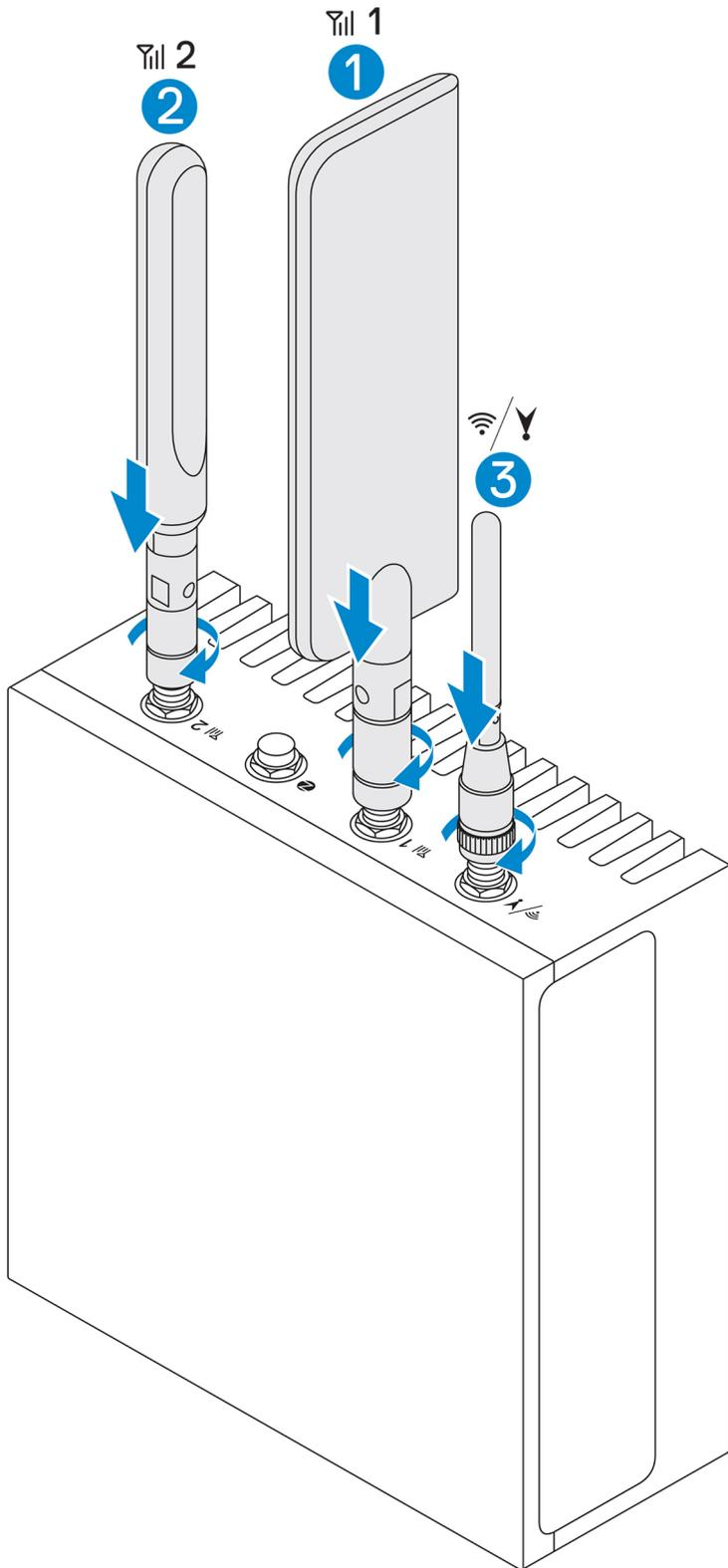
5. Coloque la antena ajustando el cabezal de rotación del conector hasta que la antena esté firmemente colocada en la posición deseada (vertical o recta).
