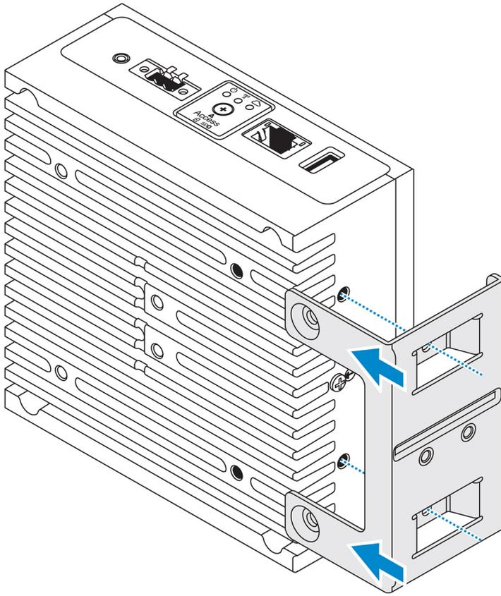
2. Apriete los cuatro tornillos M4x7 que fijan el sistema Edge Gateway al soporte de montaje perpendicular.
