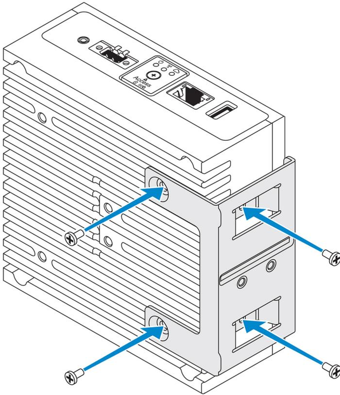
3. Alinee los orificios para tornillos del soporte de montaje de riel DIN con los orificios para tornillos del soporte de montaje perpendicular y apriete los dos tornillos.
