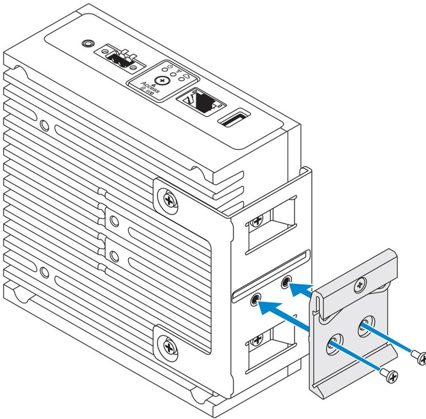
4. Coloque el sistema Edge Gateway en el riel DIN en ángulo y presione del sistema Edge Gateway hacia abajo para comprimir los muelles de los soportes de montaje de riel DIN.
