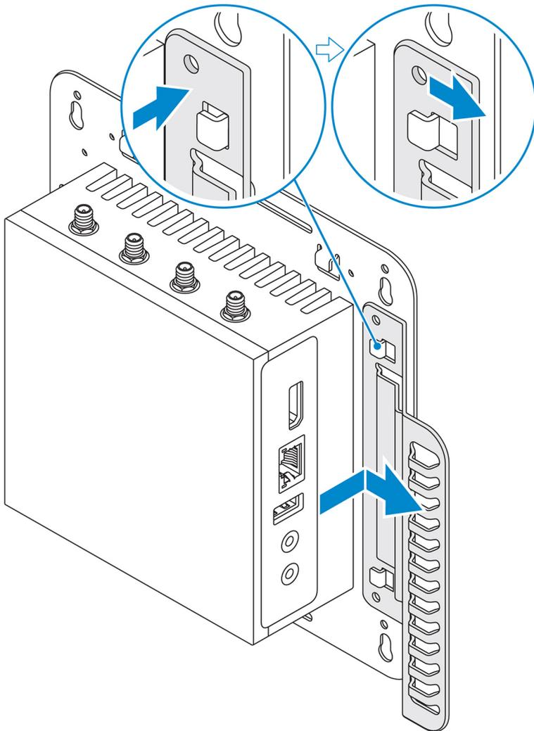
3. Alinee los orificios para tornillos de la barra de control de cables con los orificios para tornillos del soporte de montaje.
