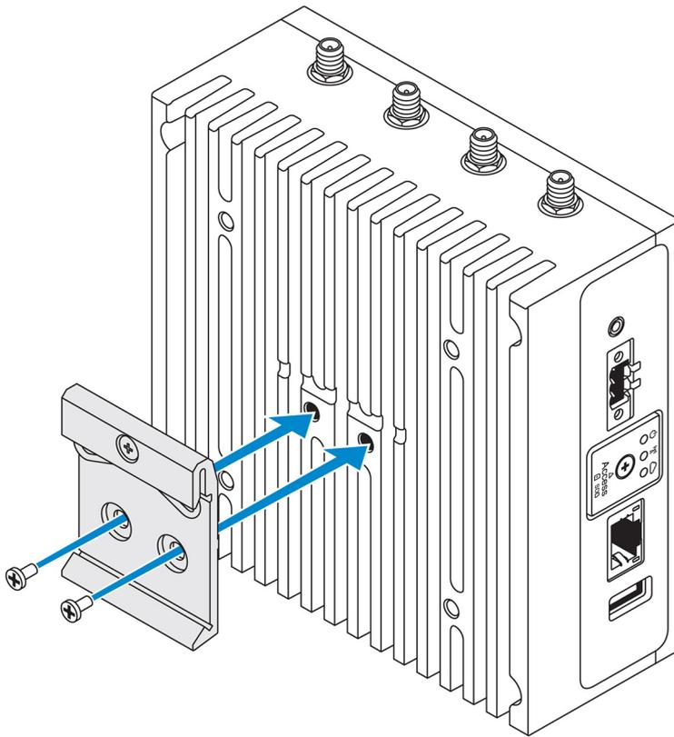
8. Coloque el sistema Edge Gateway en el montaje estándar en ángulo y, a continuación, tire del sistema Edge Gateway hacia abajo para comprimir los muelles de la parte superior del soporte de riel DIN.
