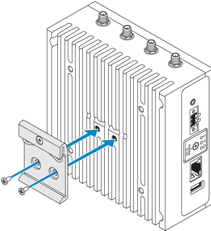
3. Fije el soporte de montaje de riel DIN al sistema Edge Gateway con los dos tornillos M4 x 5 proporcionados.
