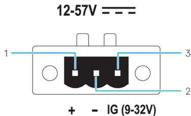
**Tabla 5. Detalles de definición de la pata del conector de alimentación**
