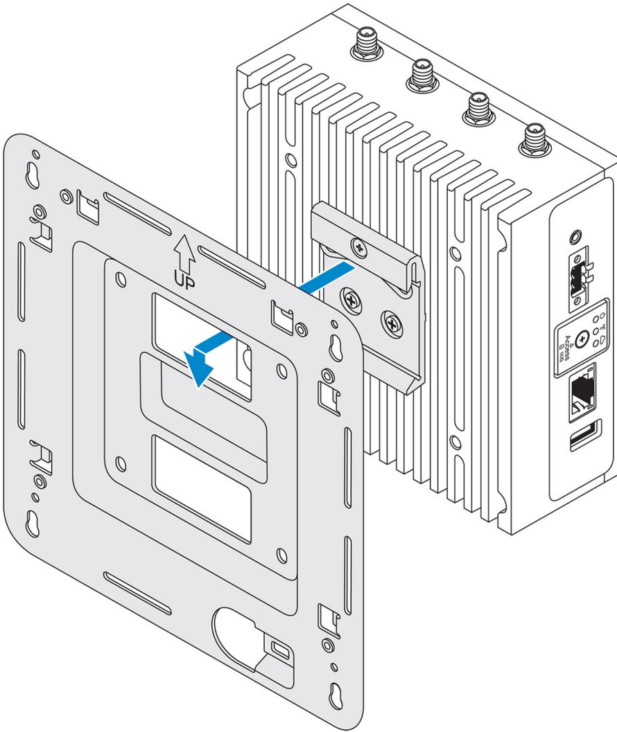
9. Empuje el sistema Edge Gateway hacia el riel DIN para fijarlo en el soporte de montaje estándar.
