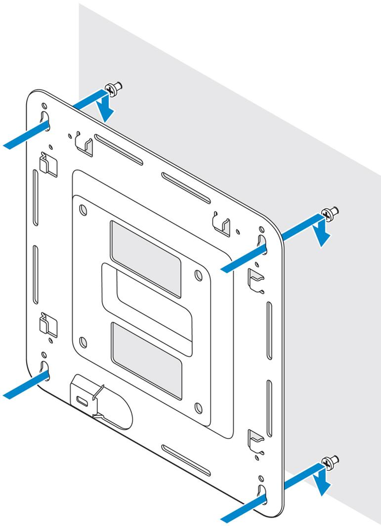
5. Ajuste los tornillos para fijar el ensamblaje a la pared.
